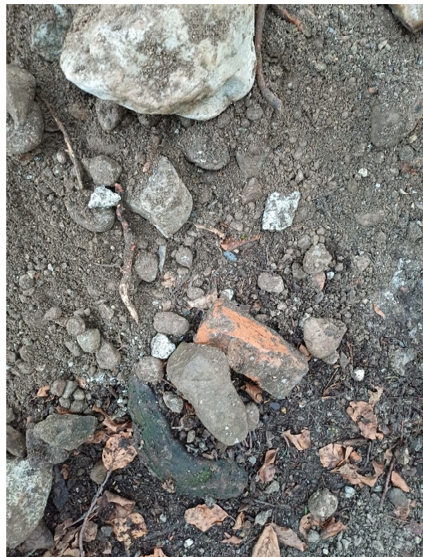
Kofferstärke bis 50cm (l), gebrauchte Materialien aus einem Abbruch, Herkunft unklar (r).
