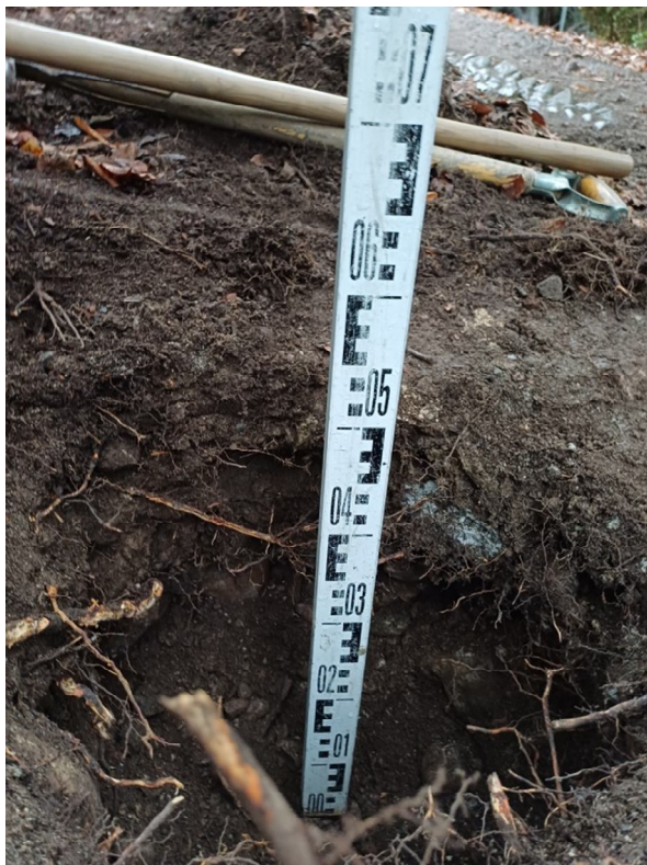
Kofferstärke bis 50cm (l), gebrauchte Materialien aus einem Abbruch, Herkunft unklar (r).
