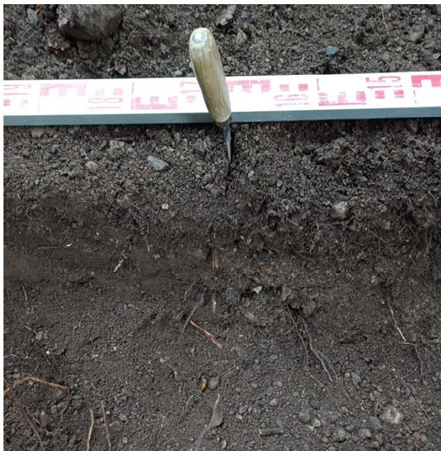
Gefundene Kofferung in der Verlängerung bestätigt Lage nach historischem Plan.
